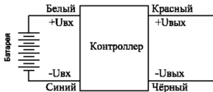
Рисунок 2. Подключение контроллера FPC-1K10 в структуре батареи
